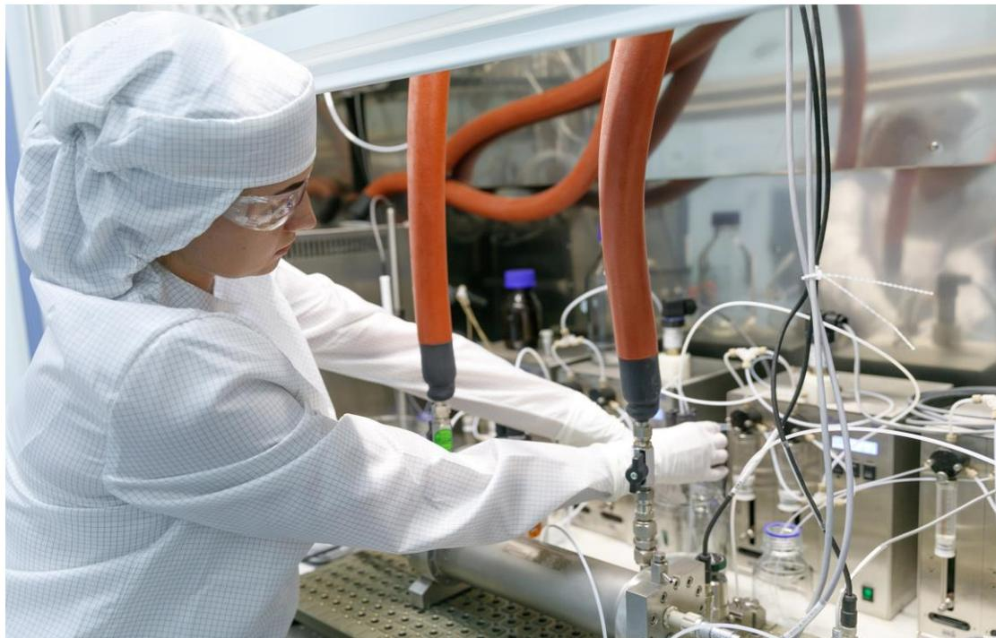
**На фото: Установка микрореакторного синтеза в РИЦ АФС позволяет спроектировать все этапы технологических процессов фармпредприятия и быстро масштабировать их в реальном производстве**
